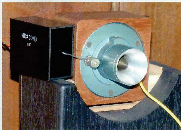
Figure 5 : Le tweeter Kato Mushroom Bell, version utilisée depuis la fin des années 1960 par Hidezumi Tanaka. Il est capable de vrais miracles sur les critères d'extraction des moindres détails sonores et musicaux. Sa rareté en a fait un élément très recherché.
