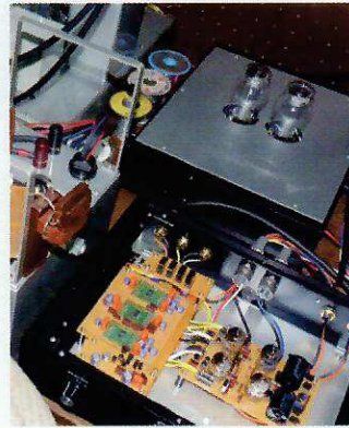
Figures 20a et 20b: Le convertisseur N/A Tanaka-Onken. Basé sur un schéma publié fin 2011, il est relié à une alimentation séparée équipée de valves de redressement WE 274B visibles en arrière-plan. Couverture de la revue MJ Audio Technology de novembre 2011, un numéro consacré à des réalisations personnelles de convertisseurs N/A.
