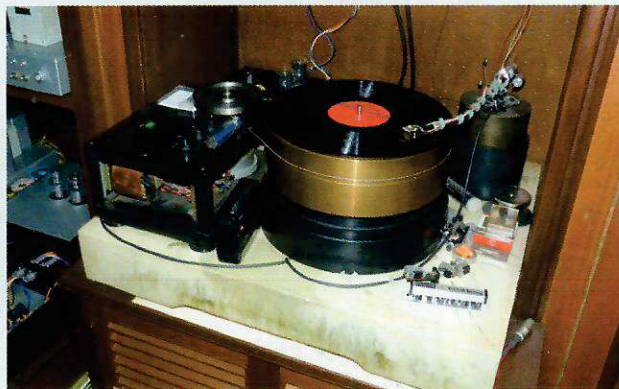
Figure 22: La platine analogique Onken. Un modèle indémodable associé ici au bras de lecture SME 3012 et à la cellule à bobines mobiles Denon DL103.
