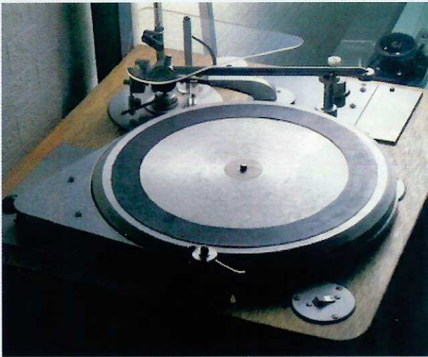
Figure 3 : Un exemple de platine vinyle lancée par Ken Kato dès le milieu des années 1950. Le plateau lourd était déjà entraîné par une courroie. Le bras de lecture de type unipivot était amorti.
