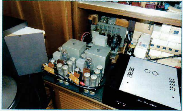
Figure 15: À gauche, un des amplificateurs montriode WE300B équipé de transformateurs de sortie Partridge TK4519. À droite, l'amplificateur Kaneda classe A 50 W + 50 W et, à sa gauche, on note la mise en place d'un déflecteur placé devant un évent de l'enceinte W.
